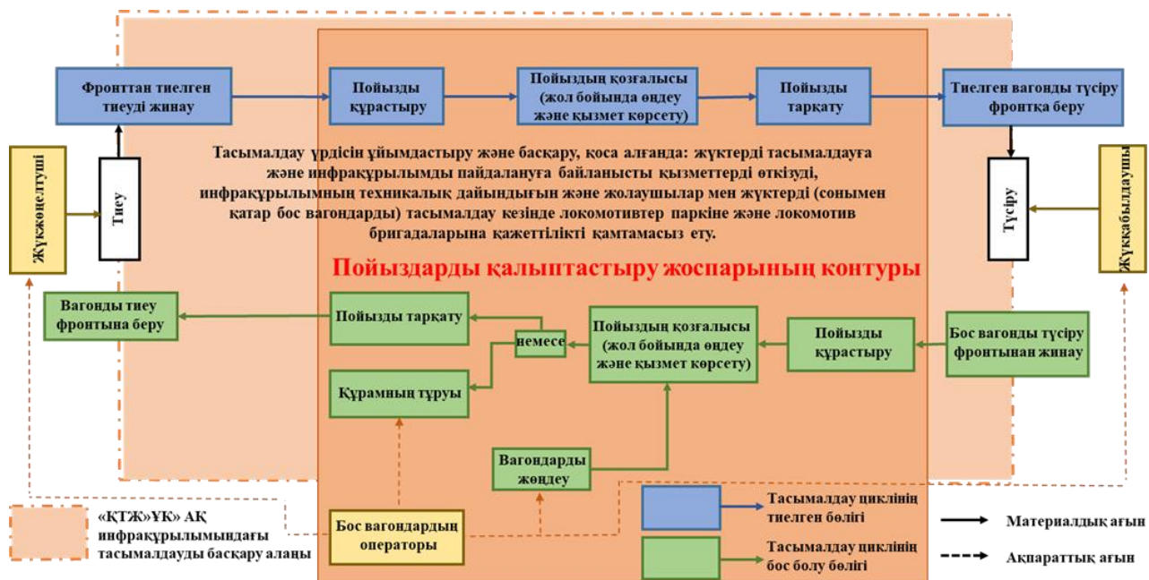
Сурет 2.9 – Техникалық станциялардың жұмысын өзара байланыстыратын пойыздарды құрастыру жоспары
